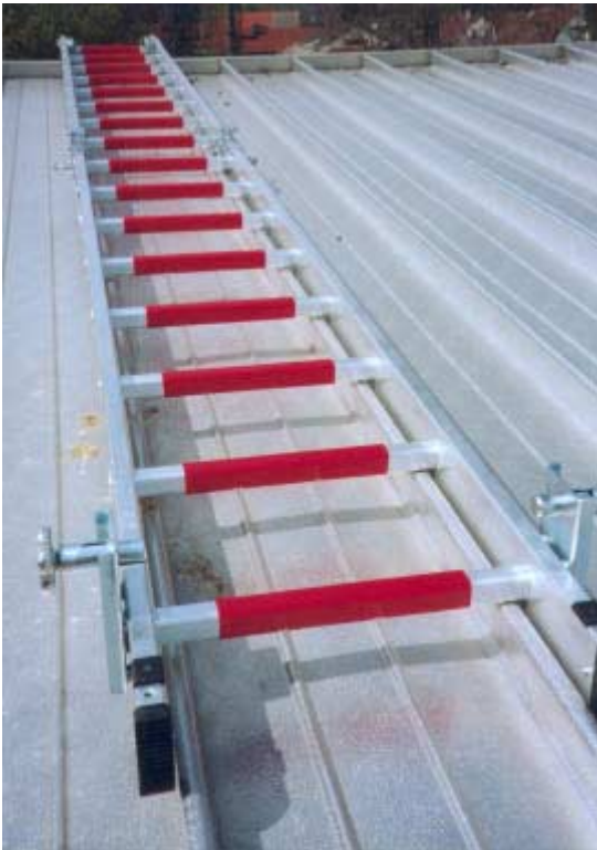
Als Dachleiter – durch Verdrehen der Haken liegen die Holme flächig auf. Beim Hochschieben der MFL auf dem Dach bilden die Haken eine Gleitfläche und eine gute Führung.
