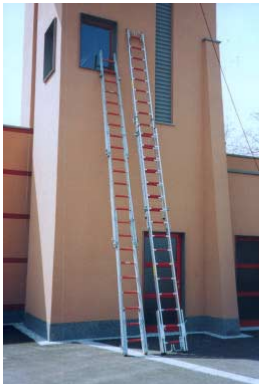
Zwei Anlegeleitern können mittels Bolzen der Verschlusselemente verbunden werden – über die Sprossenverbindung ist eine variable Höhe möglich. Vgl. zu einer dreiteiligen Steckleiter
