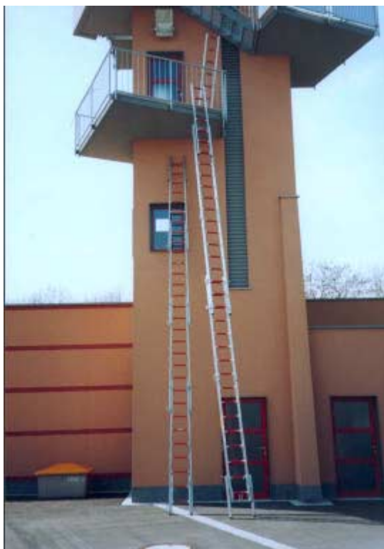
Zwei Anlegeleitern mit Aufsteckteil im Vergleich zu einer vierteiligen Steckleiter.
